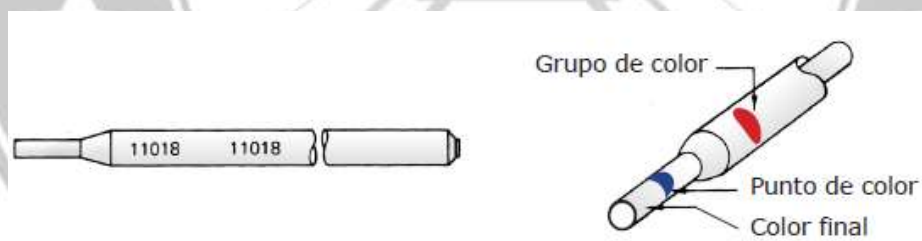
Fig. 2.4 Electrodos con identificación de colores y códigos impresos
