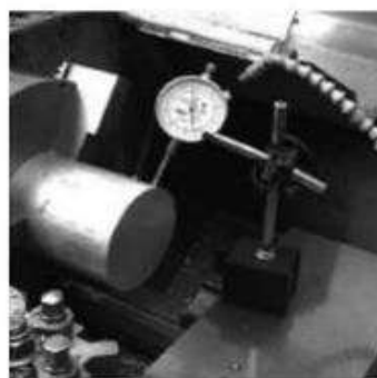
Centrado de pieza en el torno mediante reloj comparador
