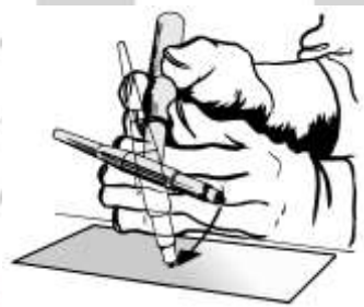
Fig. 3.4 Forma correcta de comenzar el arco con un sistema TIG
