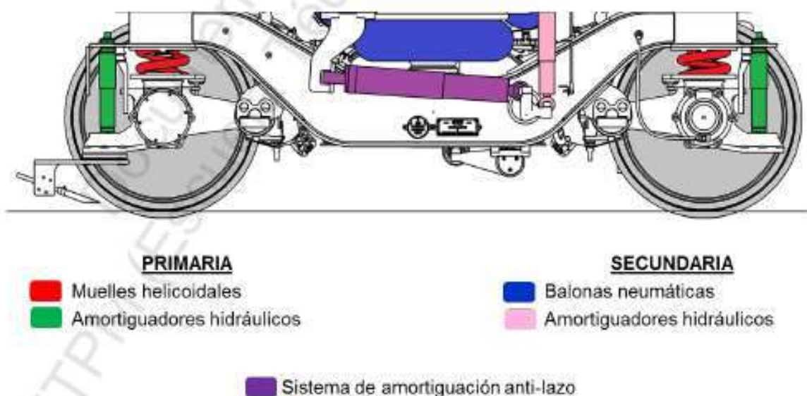
Figura. 2-55 Suspensión por balonas neumáticas
