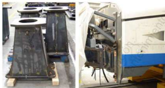
Figura 3-15 Sistema de absorción de impactos en estructura
