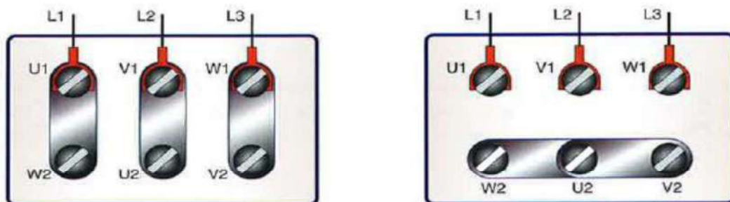
↑ Figura 4.16. Conexión triángulo y conexión estrella.
