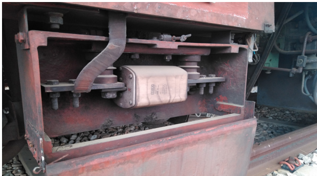
Caja portafusibles y fusible, junto a cofre del seccionador y seccionador, pertenecientes a un 1 5000ª Serie todo ello con MCA.
